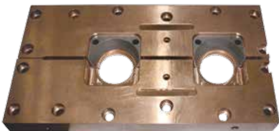
ASSAB MM40 挤出吹塑模具的颈部。
