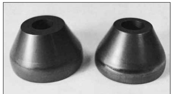
用ASSAB PM 23 SuperClean制作的有表面PVD涂层的冷成型管件模具
